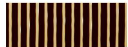
Period ~600nm Depth 700nm Top ~120nm Bottom ~330nm
